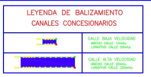
NOTA.— LA SEPARACION DE LAS BOYAS SERA DE 200mts. LONGITUD TOTAL DE BALIZAMIENTO 22.188m.
